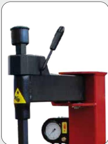
**(IT) POSIZIONAMENTO UTENSILE:** Il **posizionamento orizzontale** dell'utensile si ottiene per mezzo di un volantino filettato. Operando su più ruote delle stesse dimensioni si mantiene la regolazione iniziale. Con il **semplice azionamento di una leva** si ottiene l'alzata dell'utensile rispetto al cerchio e il bloccaggio verticale dell'albero.
