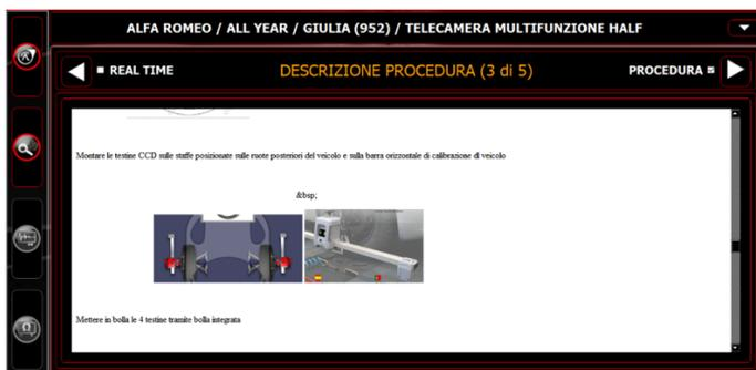
L'interfaccia utente guida l'operatore nelle varie procedure di allineamento del sistema.
