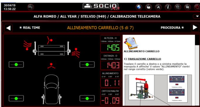
Veloce posizionamento del sistema attraverso **informazioni comunicate in «Real Time»** nel software dai diversi dispositivi presenti; **PATENT PENDING.**
