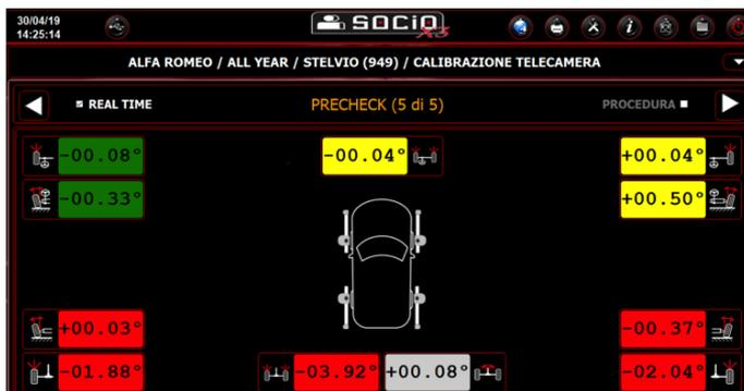
**Software AllInOne:** software di diagnosi con funzione di PreCheck per il controllo dei valori di campanatura e convergenza del veicolo secondo i requisiti del costruttore; **PATENT PENDING.**
