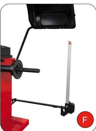
**(FR) TE-D Détecteur externe pour la mesure de la largeur de roue (en option)**
