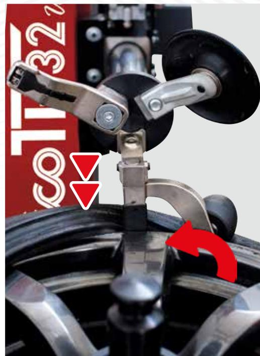
**Operação de MONTAGEM completa facilitada pela ferramenta e pelo pressionador incorporado sempre na mesma posição.**
