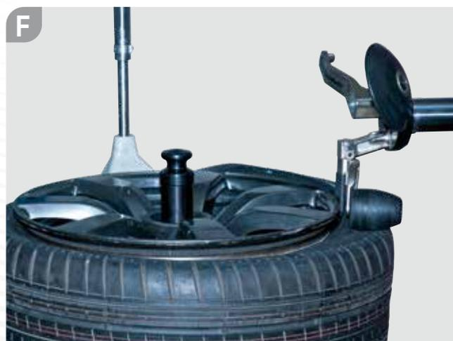
**E-F.** Posicionando a ferramenta de montagem do REVOLVER entre o aro e o pneu, automaticamente o ROLO DE PLÁSTICO do REVOLVER ajuda o pneu a ficar no canal.
