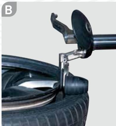
**A-B.** O DISCO DESTALONADOR superior e o rolo de plástico integrado, empurram o pneu dentro do aro.
