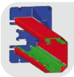
**Intern verstärkte Säulenstruktur zur Reduzierung** der Biegung und interne Kabelführung.
