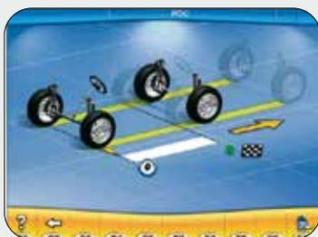
**IT PROGRAMMI DI COMPENSAZIONE «RUN-OUT»:** disponibili 2 tipologie di programmi ROC per compensare eventuali errori di «Run-Out» della ruota e possibili imperfezioni di accoppiamento graffacchione: compensazione a 3 punti ruotando la graffa di 180° e ROC a spinta che elimina la necessità di sollevare le ruote.
