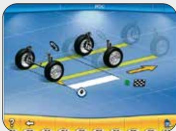
**FR PROGRAMMES DEVOILAGE «RUN-OUT»:** disponibles 2 programmes de dévoilage pour compenser imperfections géométriques de la roue ou possibles erreurs de accouplement entre griffe et jante: dévoilage à 3 points avec une rotation de la griffe de 180° et ROC en poussée qui va éliminer la nécessité de soulever le véhicule.
