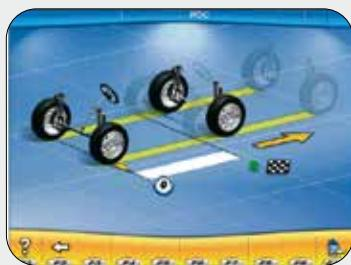
**(ES) PROGRAMAS COMPENSACIÓN «RUN-OUT»:** disponibles 2 programas de descentrado para compensar problemas sobre llanta y neumático y posibles errores causados para un incorrecto montaje de llanta y grapa autocentrante: ROC de 3 puntos tramite rotación de la garra de 180° y ROC de empuje que elimina la necesidad de levantar el vehículo.
