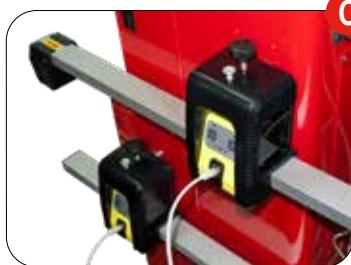
**(ES) SISTEMA ALIMENTACIÓN:** sistema alimentación tramite baterías comerciales recargables de tipo AA con dispositivo de recarga integrado sobre el cuerpo maquina. Disponibles como opcional también los cables de emergencia.
