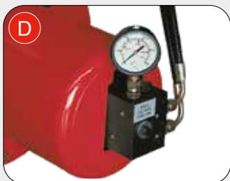
**(FR) DISPOSITIFS DE SÉCURITÉ:** Le TECO 58 M est équipé d'une série de dispositifs pour garantir la sécurité maximale de l'opérateur: clapets anti-retour sur mandrin auto-centreur, soupape de sécurité sur le système hydraulique et interrupteur magnétothermique de protection du moteur de la pompe. Bouton d'arrêt sur le manipulateur pour arrêter la machine en cas d'actionnement accidentel de la commande.
