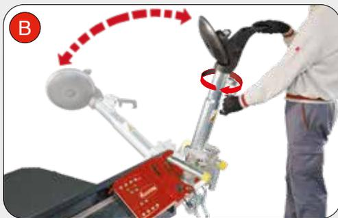
**(FR) BRAS PORTE-OUTILS:** Le soulèvement du bras porte-outils et la rotation des outils sont actionnés manuellement au moyen de dispositifs mécaniques de décrochage et d'accrochage. Le profil semi-sphérique du disque détalonneur permet d'obtenir une meilleure pénétration entre jante et pneus.
