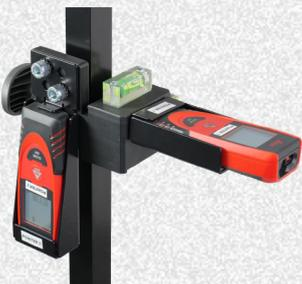
**Puntatori laser** che comunicano le misure della distanza e altezza in modalità wireless per un veloce e preciso posizionamento rispetto il sensore radar.
