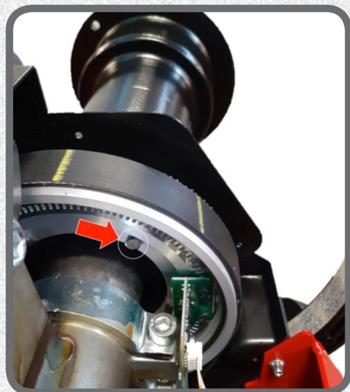
Se le suddette viti dovessero essere di colore nero (acciaio brunito ferromagnetico) occorre sostituirle con altre di dimensioni analoghe in acciaio INOX amagnetico (VTE M4X10).
